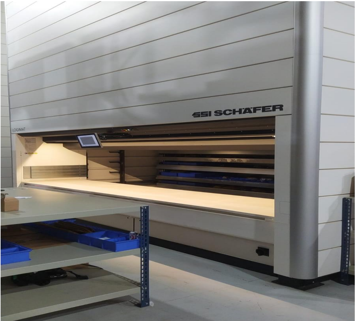
Imagem 5- Robô para armazenar e retirar peças
